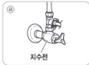
㉑ 설치되어 있던 지수전을 돌려 빼어낸 후
